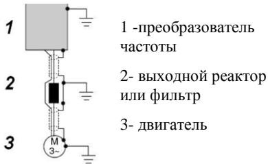
Рисунок В.2 – Схема подключения двигателя к преобразователю частоты
