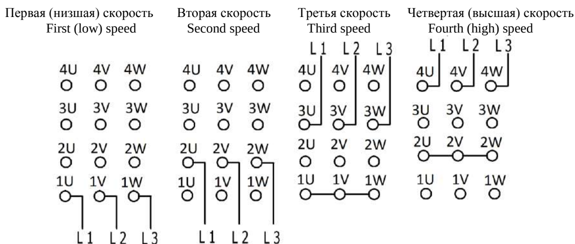
Рис. 5 - Схема подключения 4-скоростного двигателя с двумя обмотками по схеме Даландера «Δ/YY»
