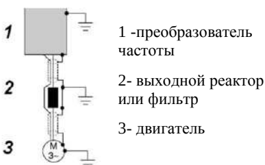
Рисунок В.2 – Схема подключения двигателя к преобразователю частоты
