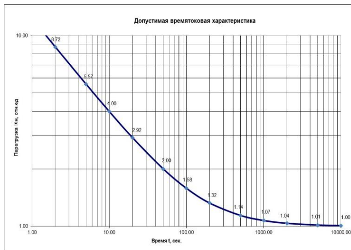
Рисунок 1 – Допустимая времятоковая характеристика асинхронного двигателя
