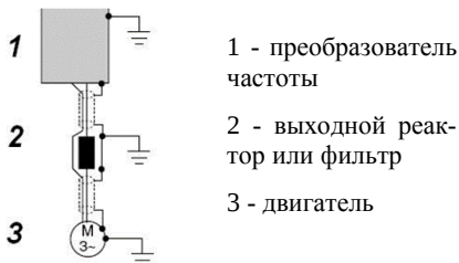
Рисунок В.2 – Схема подключения двигателя к преобразователю частоты
